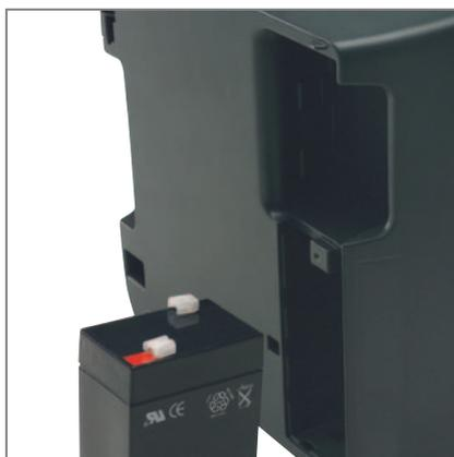
**BATTERIA INTERNA** ricaricabile e sostituibile dall'utente
